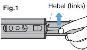
Bewegen Sie gleichzeitig den linken Hebel nach oben und den rechten Hebel nach unten.
