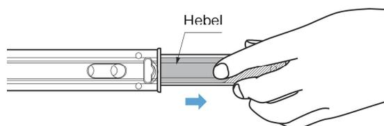
Die Schublade kann durch ziehen des Hebels in Pfeilrichtung abgenommen werden.
