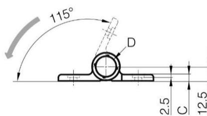
Dämpfungsrichtung wenn das Scharnier geöffnet wird.
