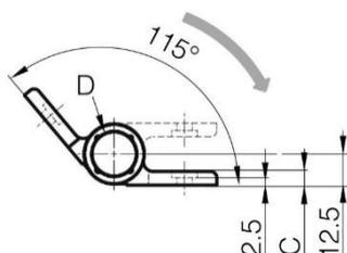
Dämpfungsrichtung wenn das Scharnier geschlossen wird.
