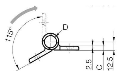
Dämpfungsrichtung wenn das Scharnier geschlossen wird.
