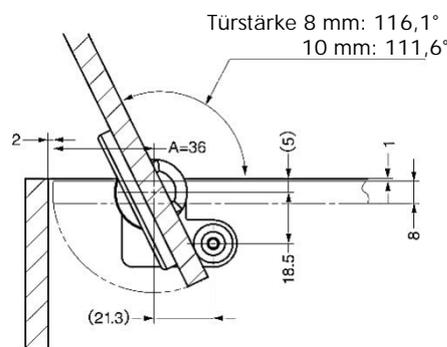
※ Wenn der Abstand vom Schraubenloch zu der Kante 5mm beträgt, wird ein Niveauunterschied von 1mm generiert.
