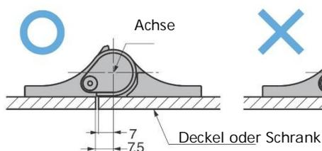
Abb. B (falsche Installation)
