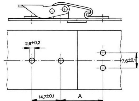
A = min. 23,7mm; Toleranzausgleich bzw. Vorspannung beim Einbau berücksichtigen
